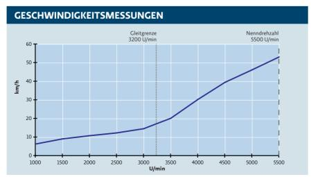
Leerlauf: 600 U/min, Höchstgeschwindigkeit: 55,3 km/h bei 5600 U/min. Gemessen mit GPS, 3 Personen an Bord, kein Wind, keine Wellen.
