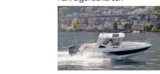
Die Bella 580 C liegt gut im Wasser. Sie lässt sich fein und präzise steuern. Das relativ tiefe V des Rumpfes sorgt für eine gute Spurtreue. Ein Aspekt, der gerade auch für Fahrschulen wichtig ist. Zudem ist das Manövrieren mit Aussenbordmotor denkbar einfach – das knapp 6 m lange Boot lässt sich praktisch auf dem Teller wenden. Bemerkenswert ist auch die gute Rundumsicht des Fahrers – egal ob stehend oder sitzend.
